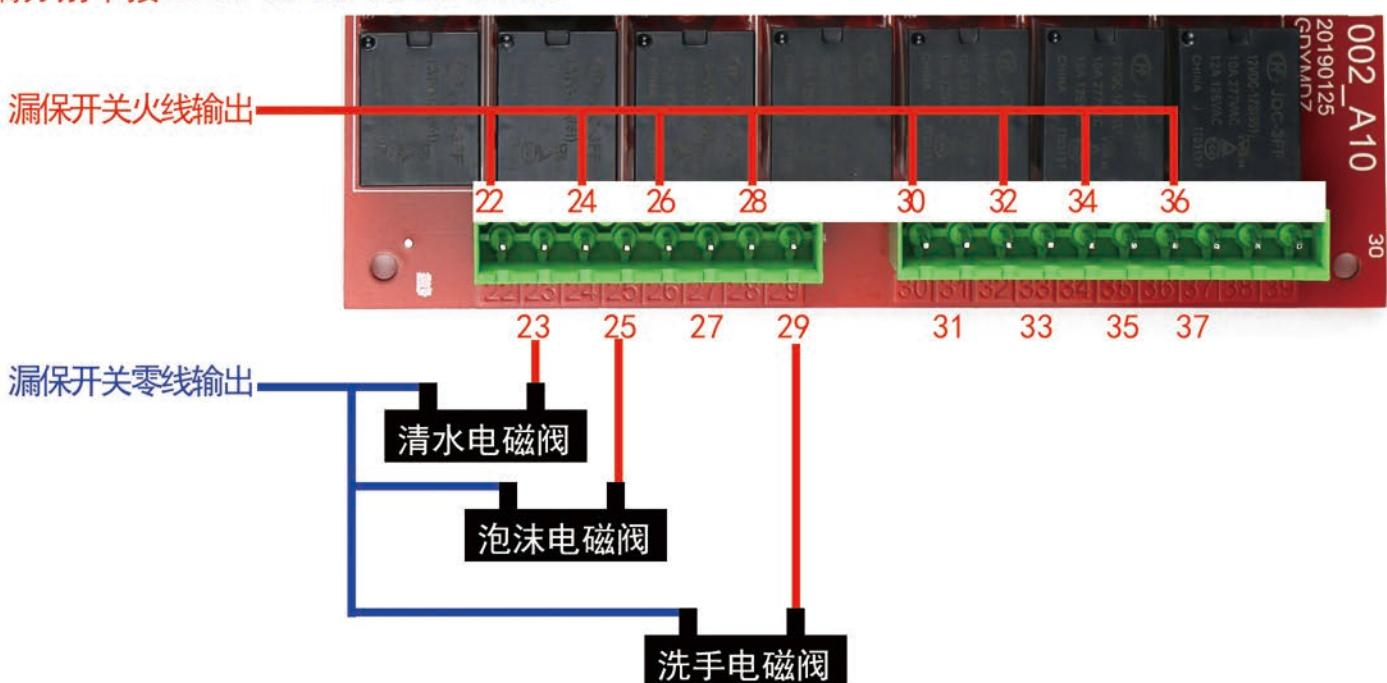
零线一起串接到漏保开关的零线端口
