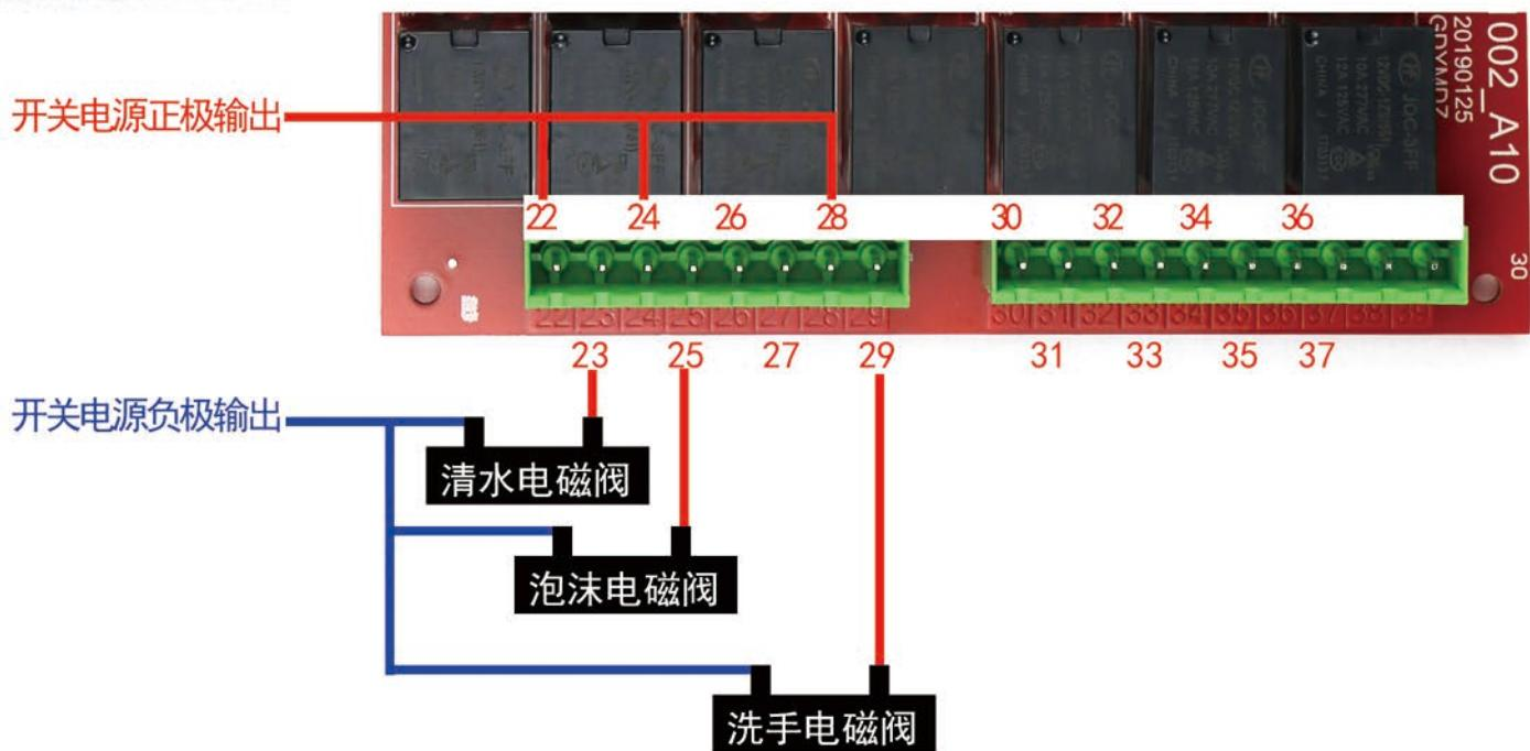
负极串接到开关电源的负极端口
