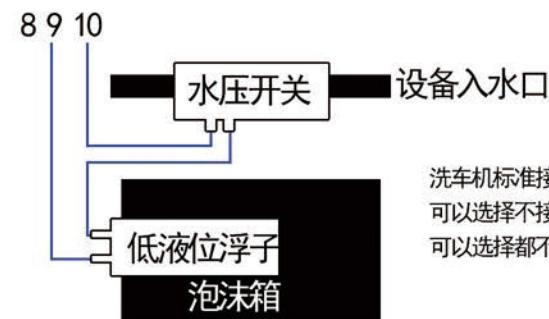
洗车机标准接法，兼顾测有无泡沫、清水
