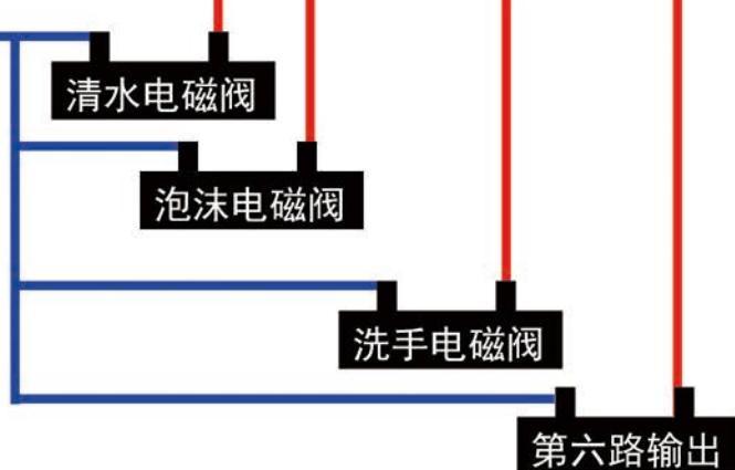
负极串接到开关电源的负极端口
