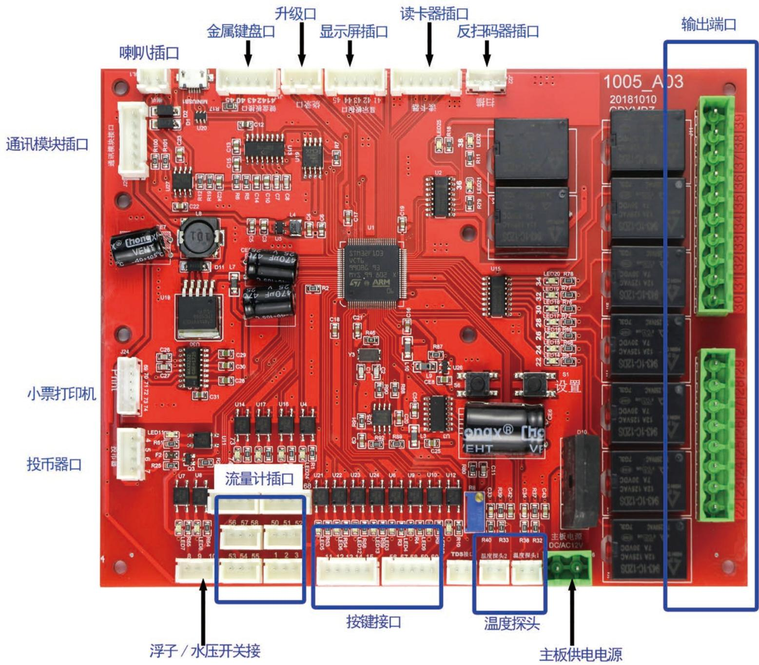
注：电池、通讯模块、金属键盘、液晶屏、升级工具、反扫码器、喇叭、小票打印机 是配好线的，其余端口接线，看详细接线部分
