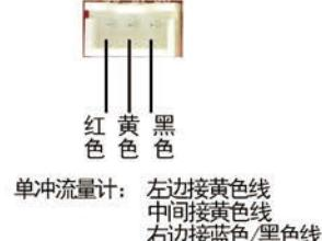
(单脉冲流量计连接线颜色，一般有 红黄黑 或 红黄蓝 两种)
